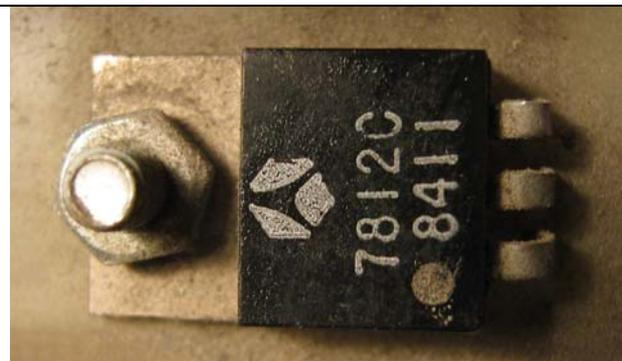
Régulateurs de tension de la série 78XX et 79XX, semblables (en apparence) à des transistors.
